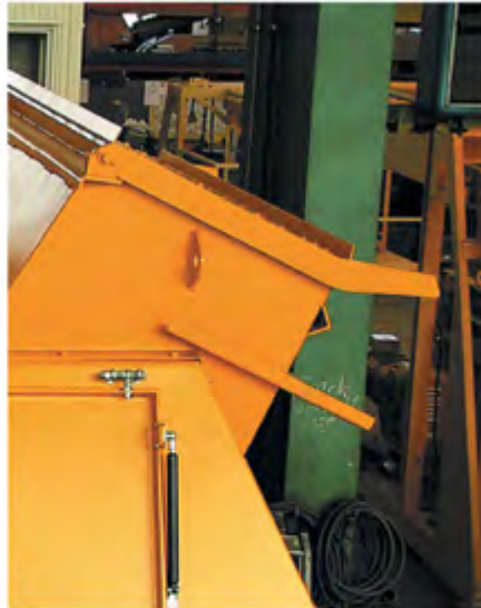
Заслінка з еластичними ущільнювачами закриває вхідний отвір для заповнювачів (опція).
