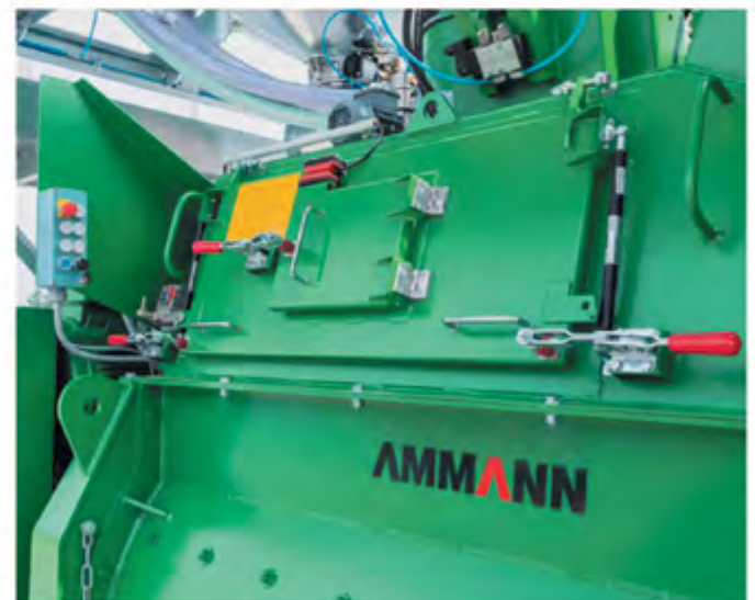
Спостереження за процесом перемішування через кришку люка, захищену від випадкових дотиків, великі дверцята для очищення.
