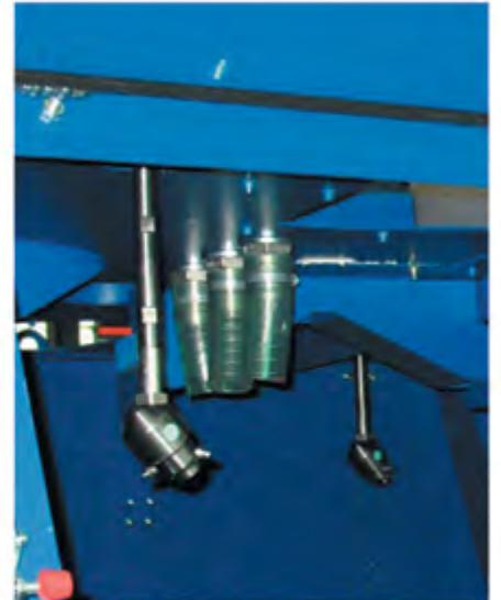
Розташування очисних форсунок (опція).
