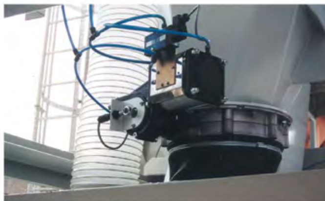
За бажанням змішувач може бути оснащений вхідними отворами для введення добавок, а також шлангом для видалення повітря, який підключається до цементних ваг і фільтру. У вентиляційному каналі прямокутного перерізу можна встановити відеокамеру з підсвічуванням. Таким чином, процес змішування можна спостерігати на моніторі (тільки в поєднанні з витяжною системою).
