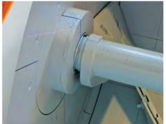
Система підшипників та ущільнення вала змішувачів серій від СЕМ S Elba 500 до 2500 гарантують надійну експлуатацію.
