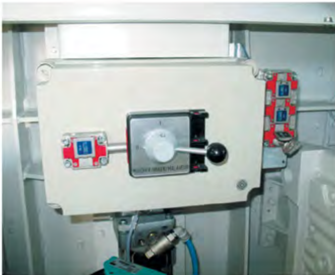
У стандартній комплектації всі оглядові люки установки додатково оснащені надійною системою блокування (відповідно до стандарту EN 1088:2008)
