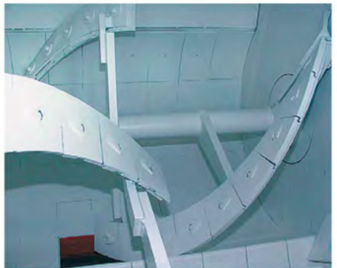
Облицювання лотка змішувача за допомогою запатентованої технології без застосування болтів.
