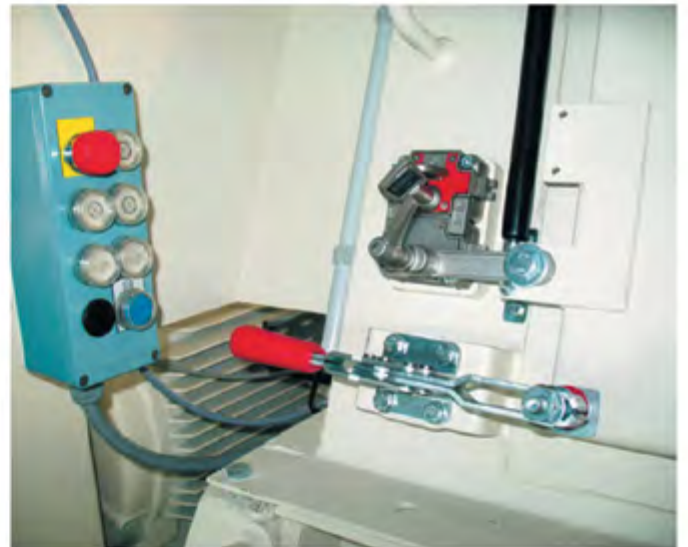
У стандартній комплектації всі оглядові люки установки додатково оснащені надійною системою блокування (відповідно до стандарту EN 1088:2008)
