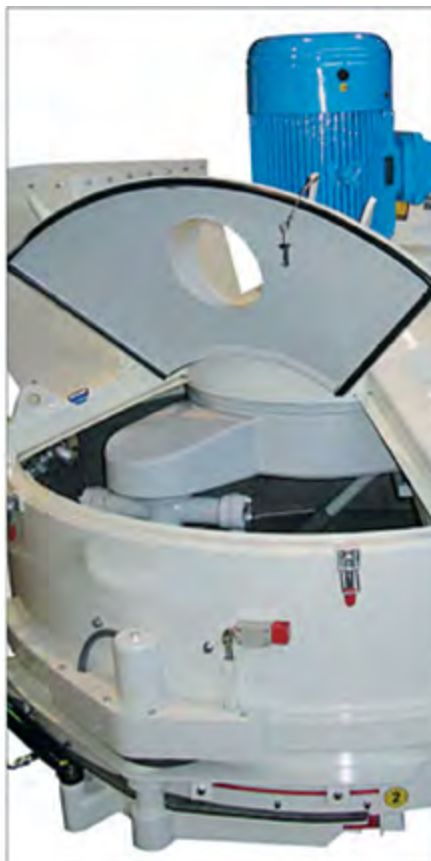
Широкі отвори для очищення. Люки знаходяться під контролем і легко відкриваються.
