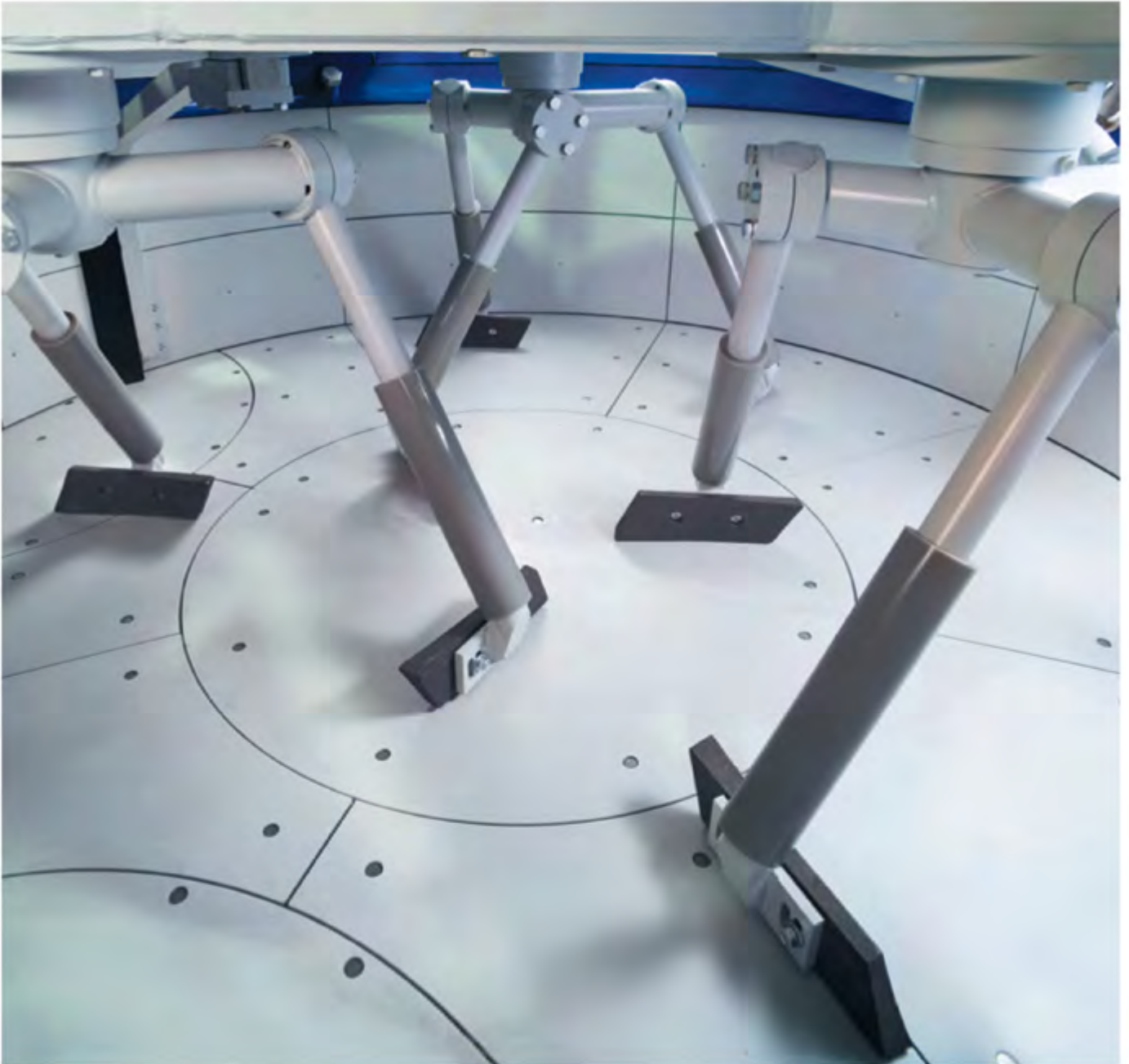
Внутрішній вигляд СЕМ Р Elba з чавунними змішувальними лопатками (стандартна комплектація).
