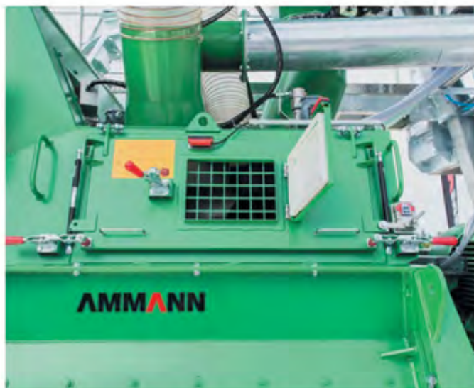
Спостереження за процесом перемішування через кришку люка, захищену від випадкових дотиків, великі дверцята для очищення.
