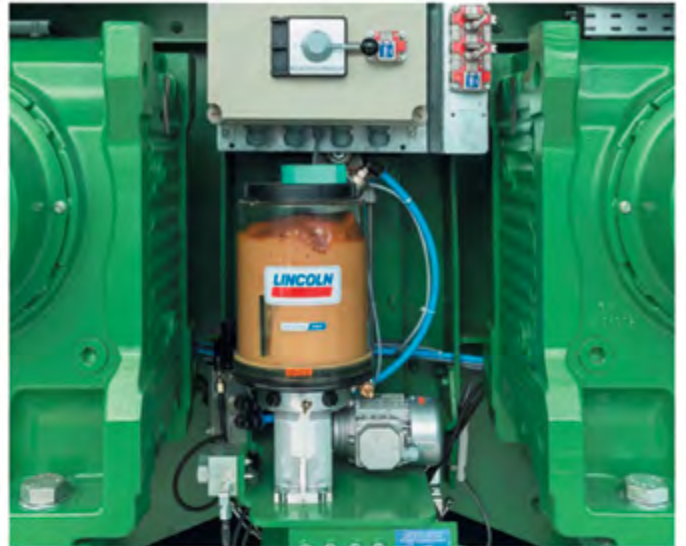
Пристрій центрального змащення з системою регулювання подачі мастильного матеріалу.
