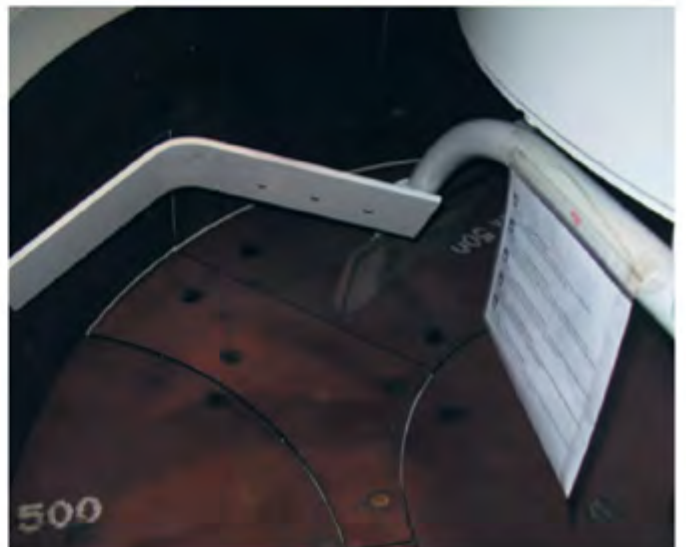
Змішувач СЕМ Р Elba з допоміжним засобом розвантаження (опція).
