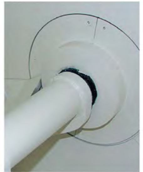
Доступ до лабіринтового ущільнення через напівкільця на внутрішній стороні змішувача зводить технічне обслуговування до мінімуму, так як відпадає необхідність зняття підшипника.
