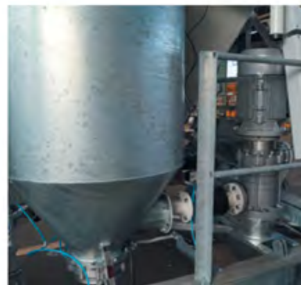
Для установок СЕМ 1000 S Elba до СЕМ 2500 S Elba у вигляді опції доступний пристрій очищення змішувача. Оснащена форсунками труба для очищення може повертатися на 270 градусів. Очищення відбувається в автоматичному або ручному режимі. Багатоступінчастий насос забирає воду для очищення, наприклад, з баку дозатору води.
