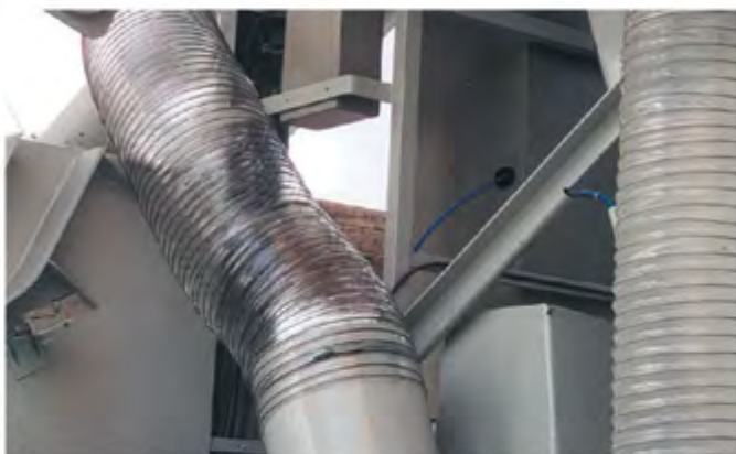
За бажанням змішувач може бути оснащений вхідними отворами для введення добавок, а також шлангом для видалення повітря, який підключається до цементних ваг і фільтру. У вентиляційному каналі прямокутного перерізу можна встановити відеокамеру з підсвічуванням. Таким чином, процес змішування можна спостерігати на моніторі (тільки в поєднанні з витяжною системою).
