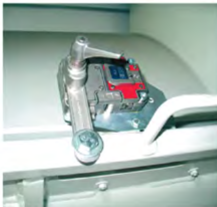
У стандартній комплектації всі оглядові люки установки додатково оснащені надійною системою блокування (відповідно до стандарту EN 1088:2008)
