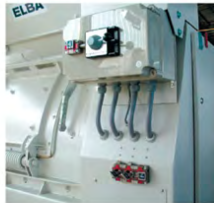
У стандартній комплектації всі оглядові люки установки додатково оснащені надійною системою блокування (відповідно до стандарту EN 1088:2008)
