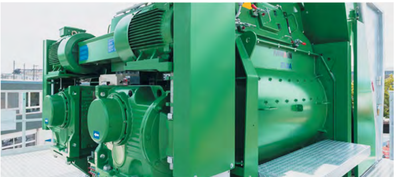
Змішувач СЕМ 3000 T Elba з боку приводу. Привід здійснюється за допомогою потужних електромоторів, зубчастого приводного ременя і конічного редуктора.
